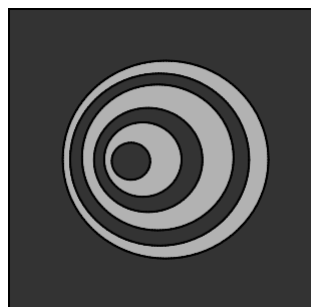
Bild 4. Sternenmuster eines nicht kollimierten Teleskops.
