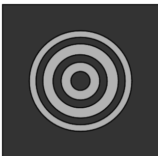
Bild 3. Sternenmuster eines kollimierten Teleskops.
