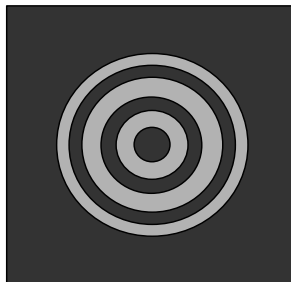
Figura 3. Patrón de una estrella en un telescopio colimado.
