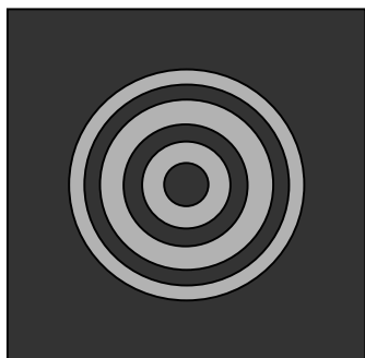
Figure 3. Aspect d'une étoile avec une bonne collimation.
