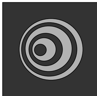
Figure 4. Aspect d'une étoile avec une mauvaise collimation.
