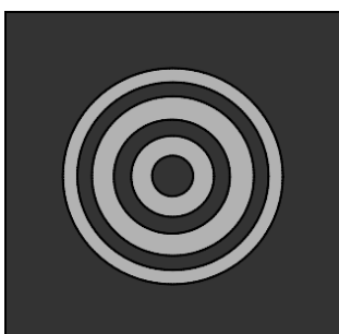
Bild 3. Sternenmuster eines kollimierten Teleskops.
