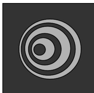
Bild 4. Sternenmuster eines nicht kollimierten Teleskops.
